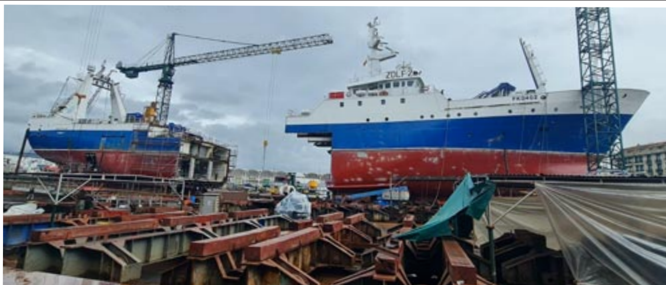
Nodosa lleva a cabo el alargamiento del New Polar para que cuente un eslora de 90 metros
